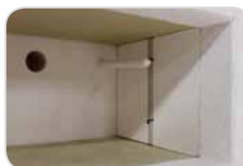
Termočlánek v komoře pece a odtahový komínek
