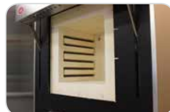
Topné spirály v drážkách vyzdívky
