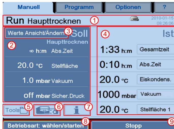
Abb. 77: Bedienoberfläche der LSCplus-Steuerung
