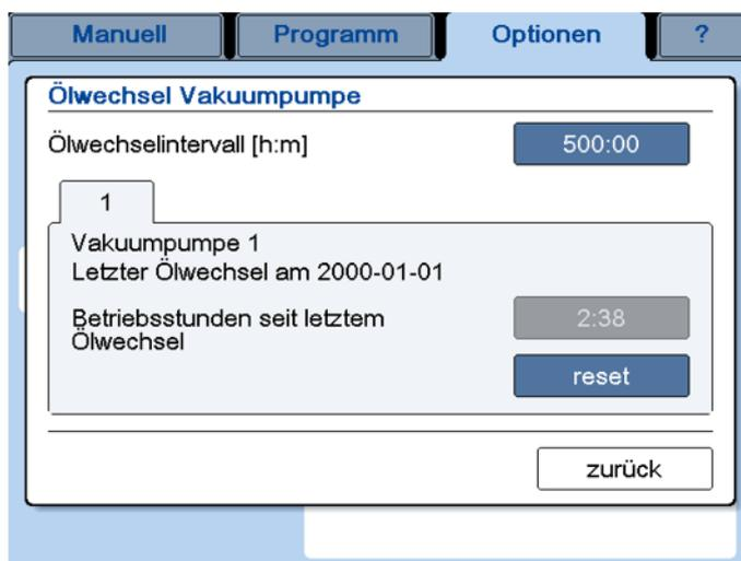
Abb. 49: Dialogfenster "Ölwechsel Vakuumpumpe"
