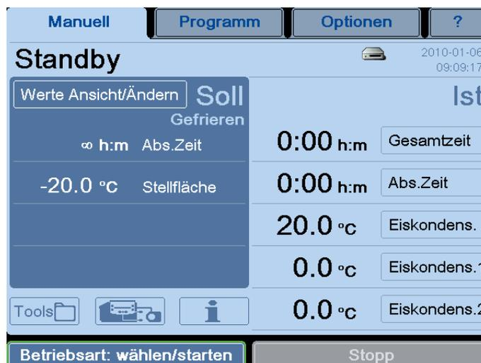
Abb. 18: Schaltflächen sind mit einem Rahmen gekennzeichnet
