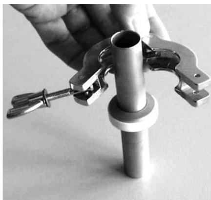
Abb. 68: Ansetzen des Spannrings
